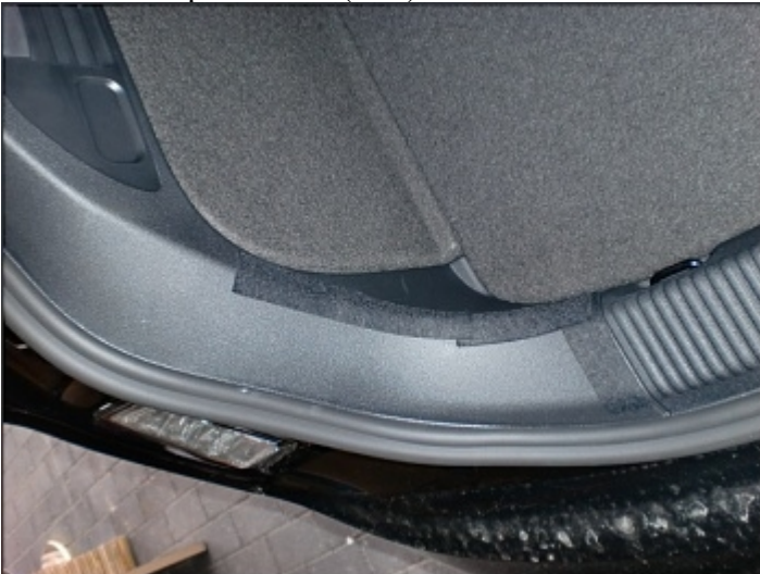
Bild 2: Transportschutz (Filz) im Kofferraum nicht entfernt
